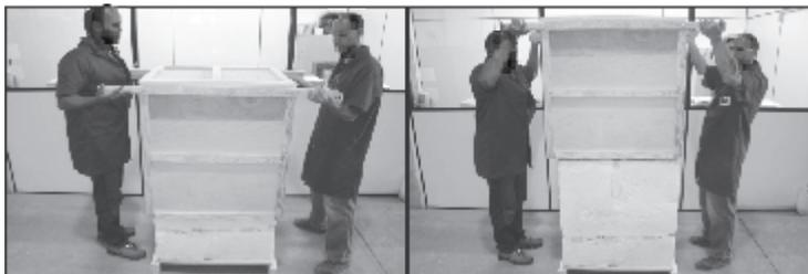
4-3) Corte as fitas adesivas nos pontos indicados para que o bloco de espuma montado em duas partes possa se soltar. Em seguida incline ligeiramente o conjunto para um dos lados e remova a primeira parte do bloco de espuma, apoiando o forno no piso **sem provocar impacto**. Proceda do mesmo modo inclinando para o outro lado, para remover o segundo bloco de espumas, conforme figuras abaixo.
