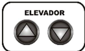
As teclas **ABRE (02)** e **FECHA (01)** do painel, acionam manualmente o elevador e sobrepõem as funções automáticas programadas na tecla **ELEV. (11)**. Estas teclas funcionam como uma chave interruptora. No primeiro toque **LIGA** e permanece ativada, no segundo toque **DESLIGA** e permanece desativada.
