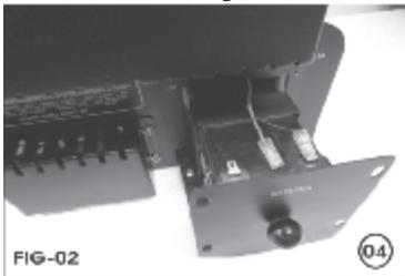
**5-4-** Remova os parafusos de fixação do compartimento da bateria e puxe o conjunto para fora do painel, com cuidado para não cortar os fios de alimentação da bateria.
