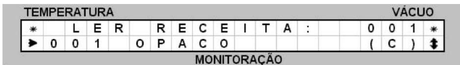
Em seguida acione a tecla **DEL (19)**. Uma tela de confirmação será escrita no visor. Mova o cursor para a opção **(SIM)** através das teclas de **navegação (16)** e confirme a operação com a tecla **OK (17)**. Ex.
