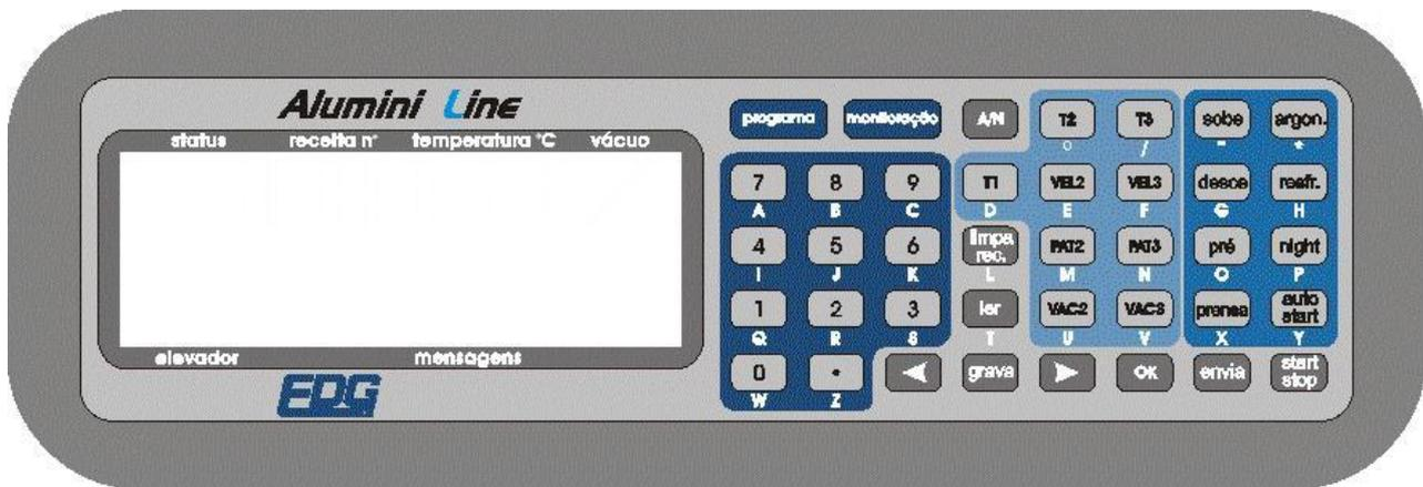
17-1 ) O teclado alfanumérico, possui 39 teclas de funções de programação e monitoração do sistema de queima, dividido em blocos, numérico, alfabético, funções auxiliares e controle.
