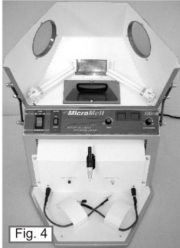
Para facilitar o acesso e manutenção nas áreas internas, o gabinete da Micromelt abre para cima.
